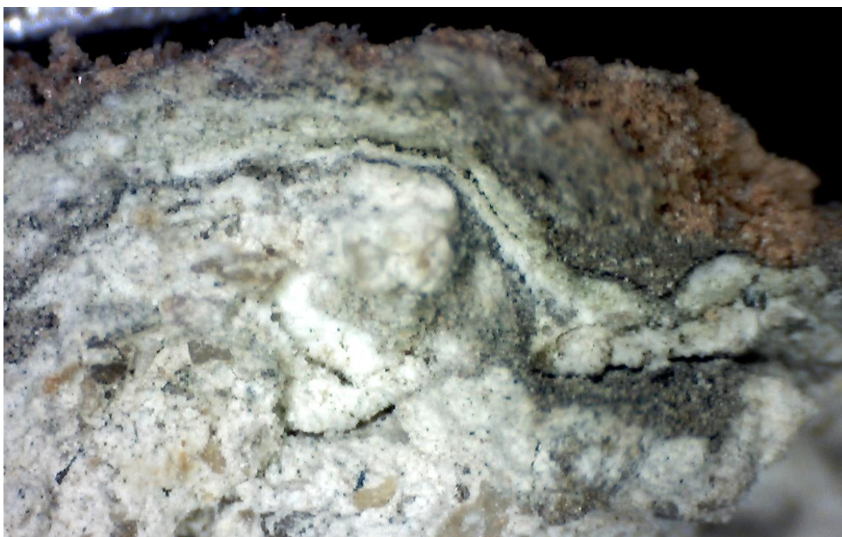
Vzorek C/7 – výstavba povrchových úprav při makroskopickém zvětšení.
