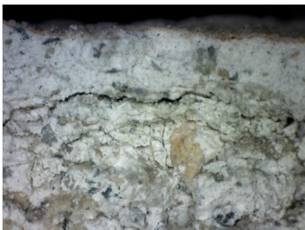
Vzorky F/1 a F/2 – výstavba povrchových úprav při makroskopickém zvětšení.
