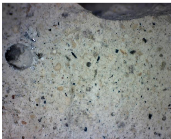
Charakteristický vzhled románského cementu při makroskopickém zvětšení.
