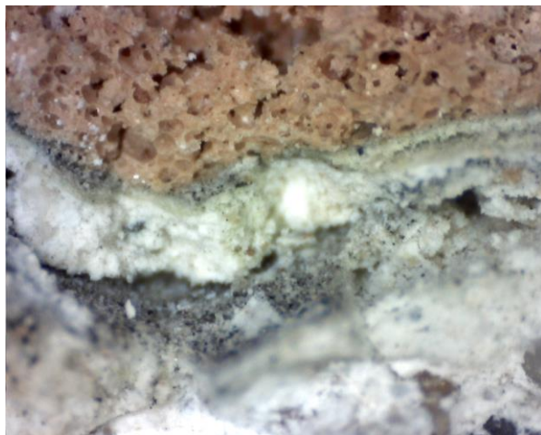
Vzorky C/3 a C/4 - detaily – výstavba povrchových úprav při makroskopickém zvětšení.
