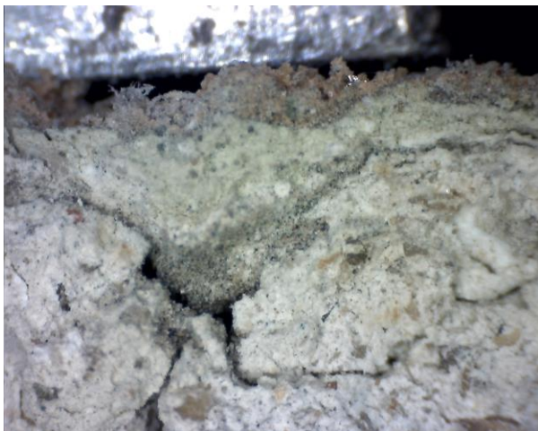
Vzorky C/3 a C/4 - detaily – výstavba povrchových úprav při makroskopickém zvětšení.
