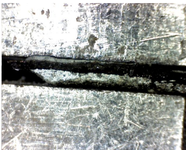
Vzorky CH/1 a CH/2 – výstavba povrchových úprav při makroskopickém zvětšení.
